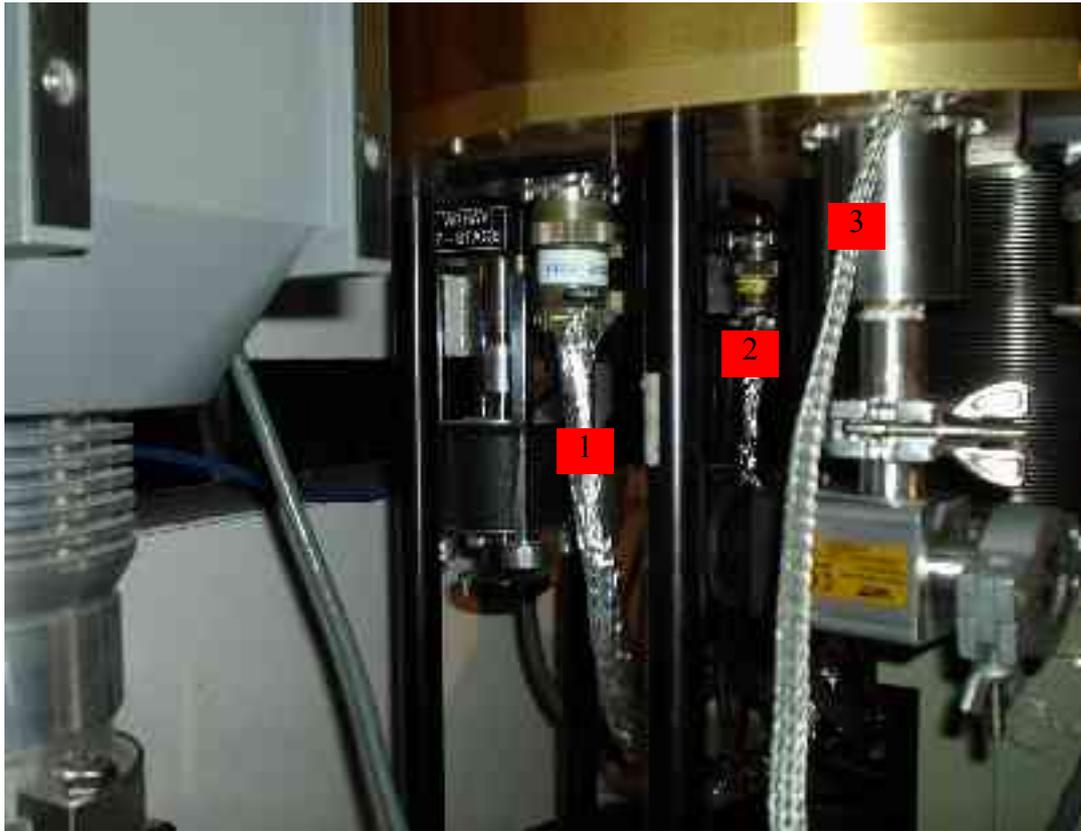
Figura 11. Connettori sul sensore (1,2) e connettore di massa sul dewar (3).
