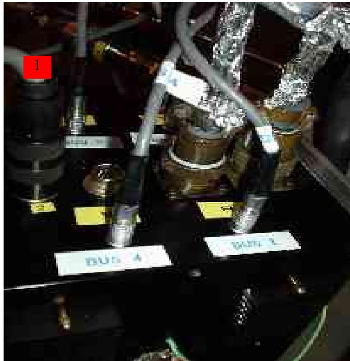
Figura 7. Connettori sulla parte superiore della scatola dell'elettronica di conversione. Il connettore di alimentazione (1) si attacca sulla presa etichettata J2, i connettori che dai 4 quadranti del rivelatore portano il segnale ai convertitori sono etichettati BUS 1-4.
