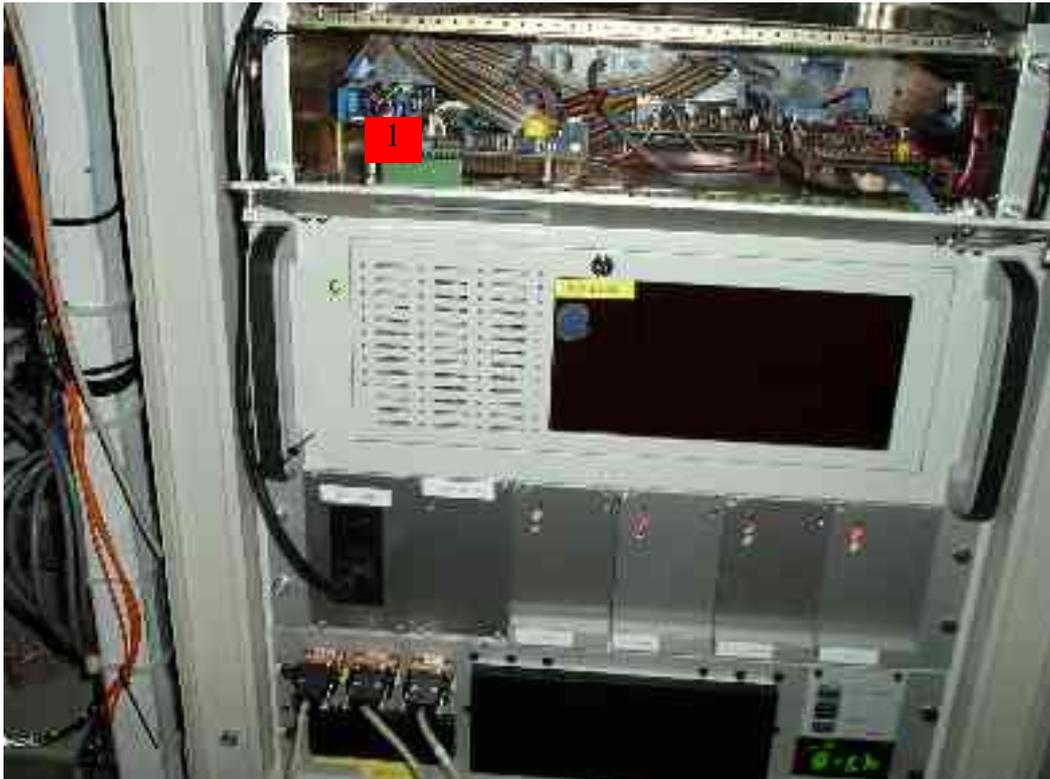
*Figura 13. Vista interna del modulo dell'elettronica di Fasti. Quando si accende l'elettronica, se la temperatura è troppo bassa, si può scaldare la scheda di buffer (1) con il phon per qualche minuto per raggiungere più in fretta la temperatura operativa.*
