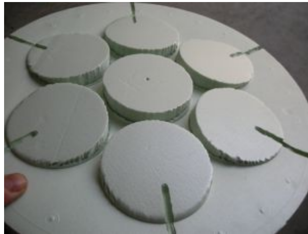
Fig. 1: Lato inferiore del supporto di Styrodur della finestra da vuoto del ricevitore Multifeed a 22GHz dopo circa 2 anni di lavoro.
