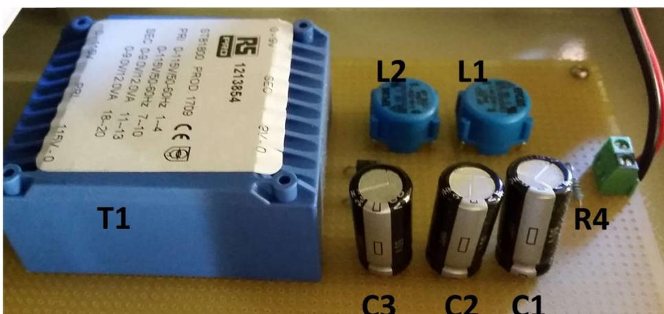
Fig.7: Immagine dell'alimentatore a 12 Volt
